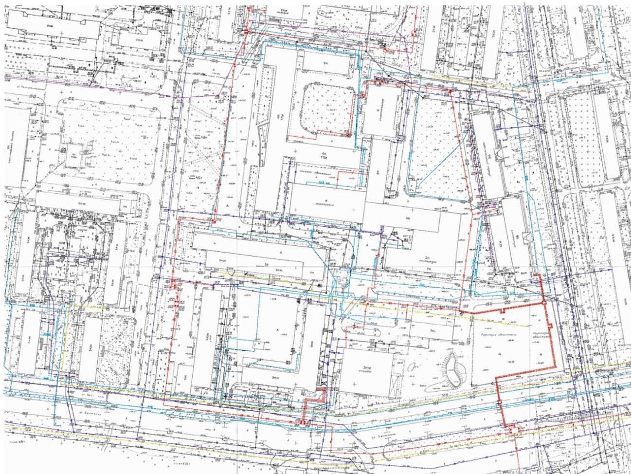
Рис. 17 – Топографическая съёмка территории кампуса с выделением коммуникаций
